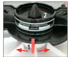
Dirección de esparcir ajustable (1), Mezclador (2)
