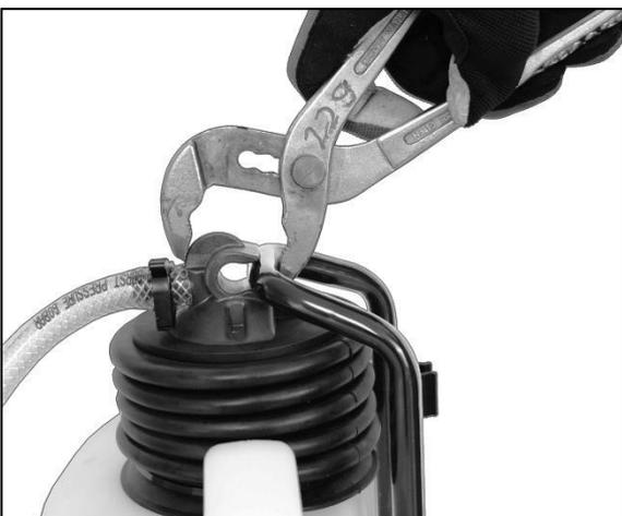
Bei der Montage des Hubgestänges eventuell eine Rohrzanze zur Hilfe nehmen.
