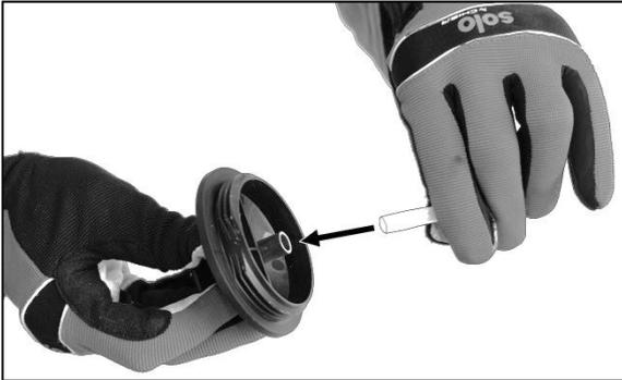
Der Saugschlauch muss ganz in der Aufnahme an der Unterseite des Windkesselschlusses stecken. Gegebenenfalls den Saugschlauch wieder korrekt in die Aufnahme stecken. Bevor das Ende in den Windkesselschluss gesteckt wird, empfehlen wir das Ende die Oberfläche mit etwas Schmirgelpapier aufzurauen und mittels eines Tropfens mit Acrylat Klebstoffs diesen zu benetzen und danach in die Aufnahme stecken.
