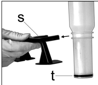
Mit einer Hand in den Spritzmittel tank greifen und den Rührer (s) vom Kolben abnehmen.
