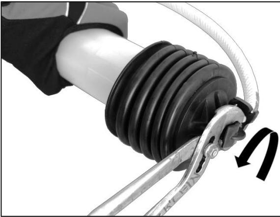
Den Windkesselsverschluss mit Hilfe einer Rohrzanze entgegen des Uhrzeigersinns aus der Pumpe herausschrauben.
