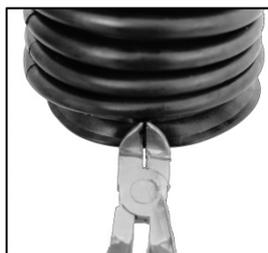
Sollte am Faltenschlauch bereits ein Kabelbinder montiert sein ist dieser abzuschneiden.
