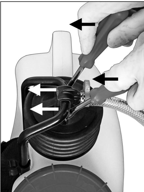
Sollte beim Pumpen kein adäquater Druckaufbau möglich sein, könnte sich eventuell der Saugschlauch aus der Aufnahme am Windkesselverschluss gelöst haben.
