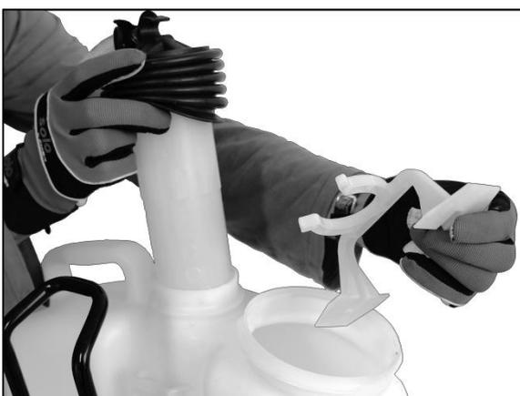
Die Pumpe nach oben aus dem Spritzmittel tank herausnehmen.
