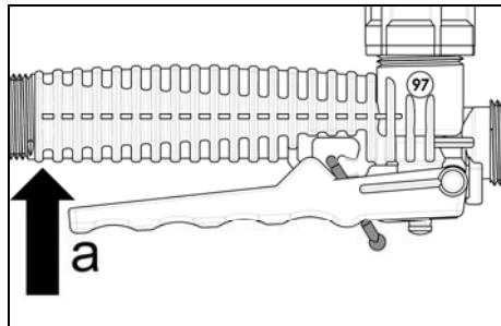
Durch Loslassen des Handventils wird der Spritzvorgang unterbrochen.
